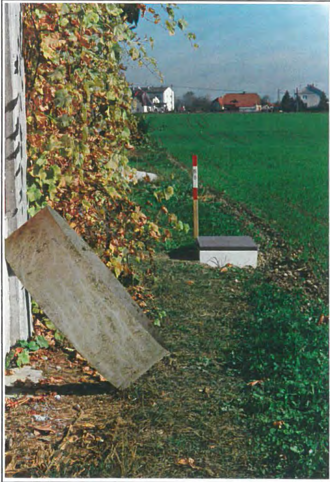
Foto 5: Stahlblechring für die Bearbeitungstiefe - Lysimeter "Pucking", dahinter Sickerwassersammler A
